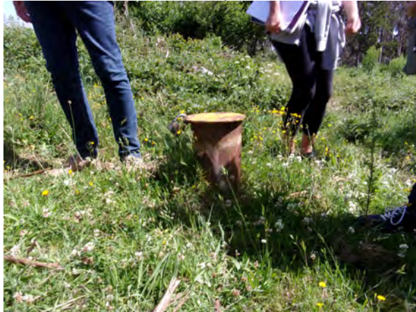
Forage à protéger et à transformer en piézomètre
