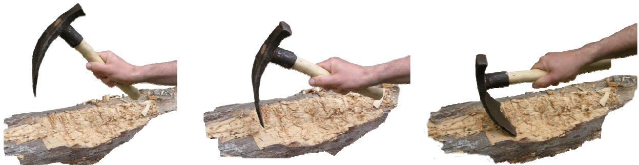
▲ Travail de dégrossissage d'un bloc de bois à l'aide d'une herminette*
