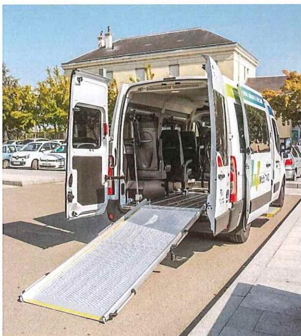
Les véhicules Master 9 places dédiés à la réalisation des services TPMR et TAD sont accessibles grâce à une rampe manuelle basée à l'arrière du véhicule.
